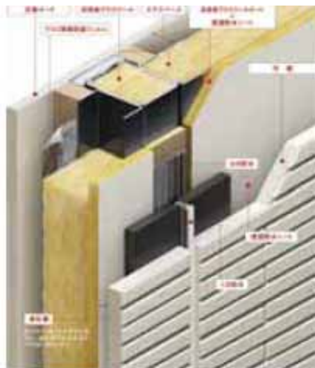
外張断熱通気外壁
