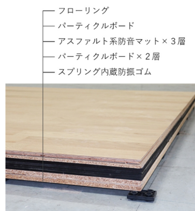
図3 ダイワ式防音乾式浮き床
