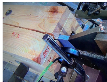
(b) 座屈拘束材端部の割れ (LY-2.25-2)
