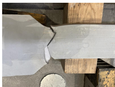
(b) 芯材の破断部 (SN-1.5)
