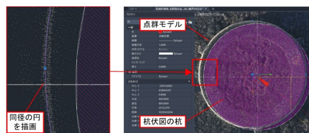
図 4 点群モデル上での杭芯位置計測
