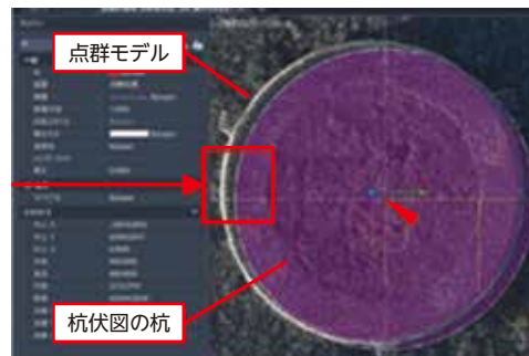
点群モデル上での杭芯位置計測
