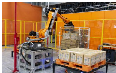
MUJIN：知能パレタイズロボット+ AGV自動化ソリューションパッケージ
