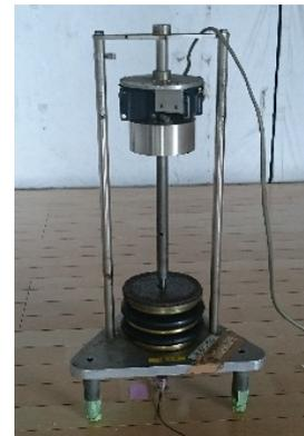
写真 1 衝撃力発生装置
