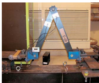
寒冷地でも性能を発揮するための -10℃の環境における性能確認試験
