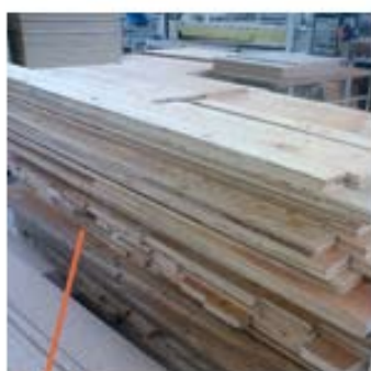
改善前 床パネルで出る28mm 針葉樹合板の端材
