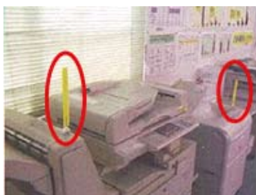
コピー機への表示バーの設置 (鹿児島工場)
