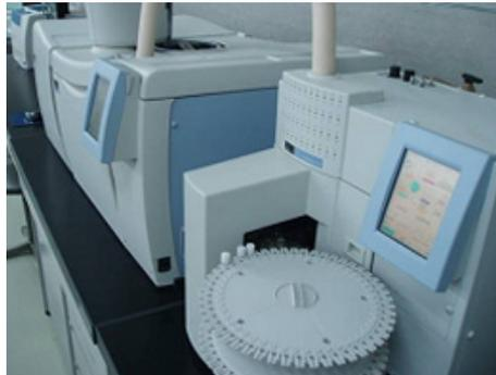
社内分析試験の状況(ガスクロマトグラフ質量分析装置)
