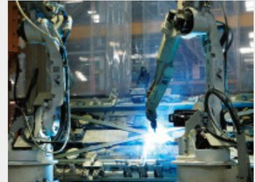
外壁パネルフレームラインでは鉄骨の溶接を自動化。コンピュータ制御により、安定した品質の製品が作られています
