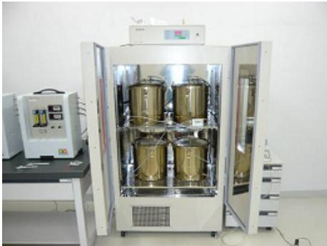
小形チャンバー法によるVOC放散測定実施状況
