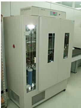
小形チャンバー法によるVOC放散測定実施状況
