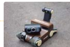
床下点検ロボット「moogle」
