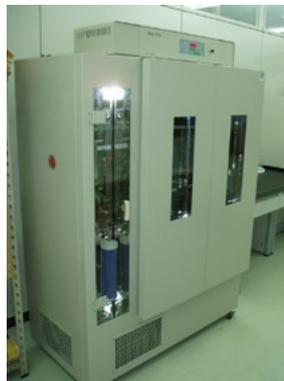
小形チャンパー法によるVOC放散測定実施状況
