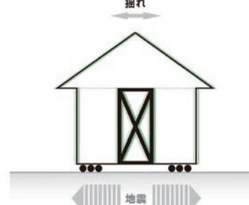
基礎と土台の間の免震層で地震の揺れを受け流します。
