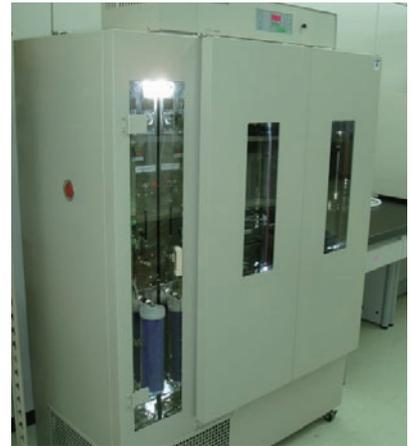
小形チャンバー法によるVOC放散測定実施状況
