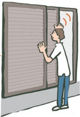
雨戸のがたつきがないかチェック。
