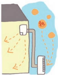
室外機の前に物を置いて空気の吹き出し口をふさがないように。
