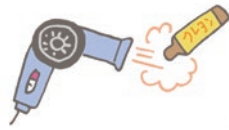
クレヨンタイプの補修剤の先端をドライヤーで温める
